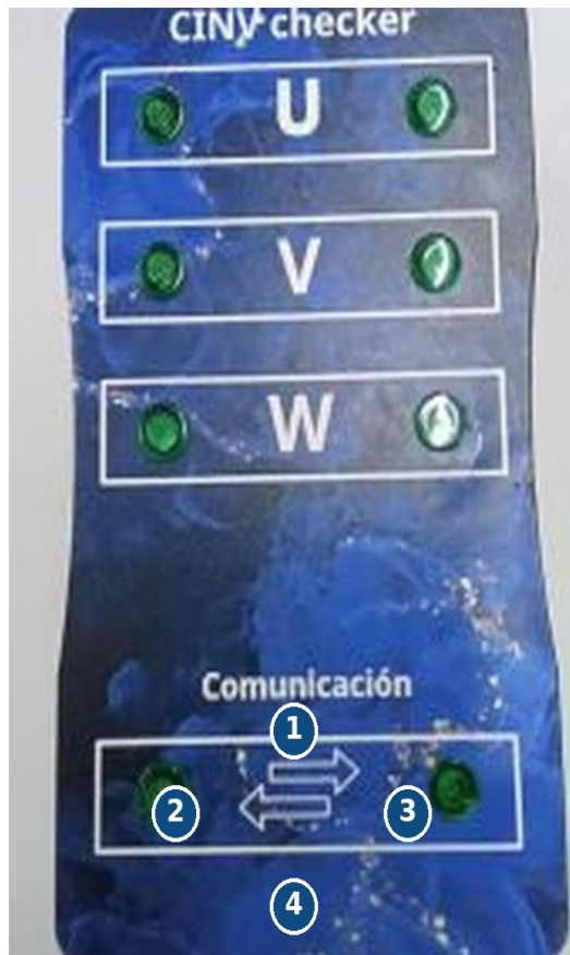
Figura 1. Identificación de la zona de comunicación en el comprobador actual.
