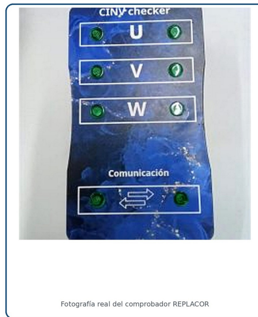
Fotografía real del comprobador dos en uno: salida inverter U-V-W y comunicación.
