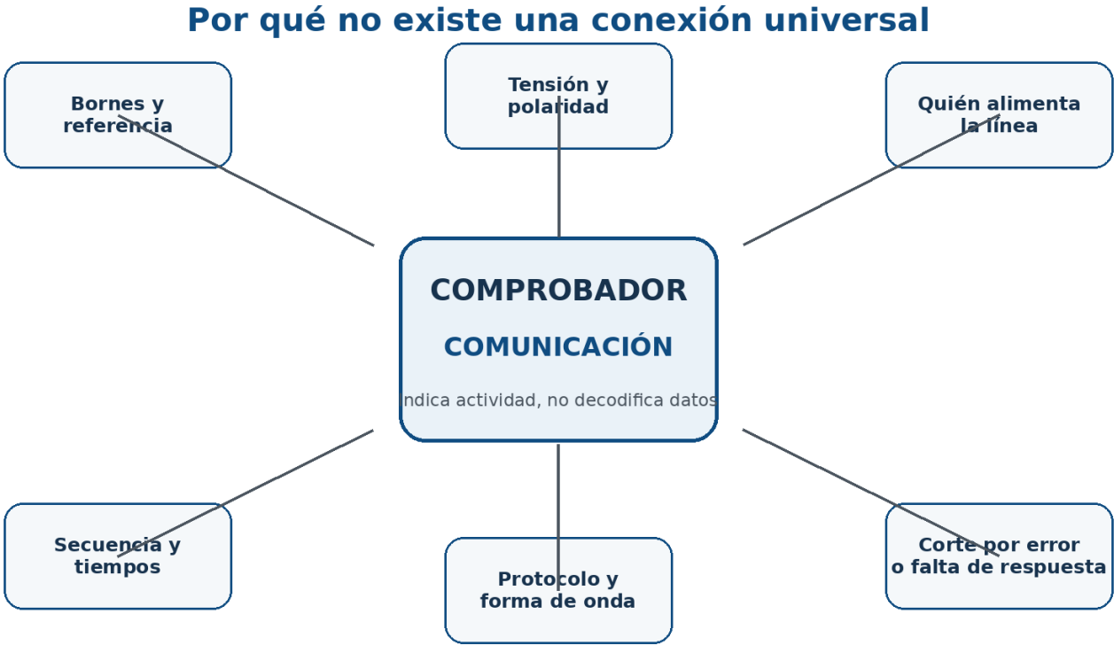
Figura 3. Parámetros que pueden cambiar entre marcas, gamas y modelos.
