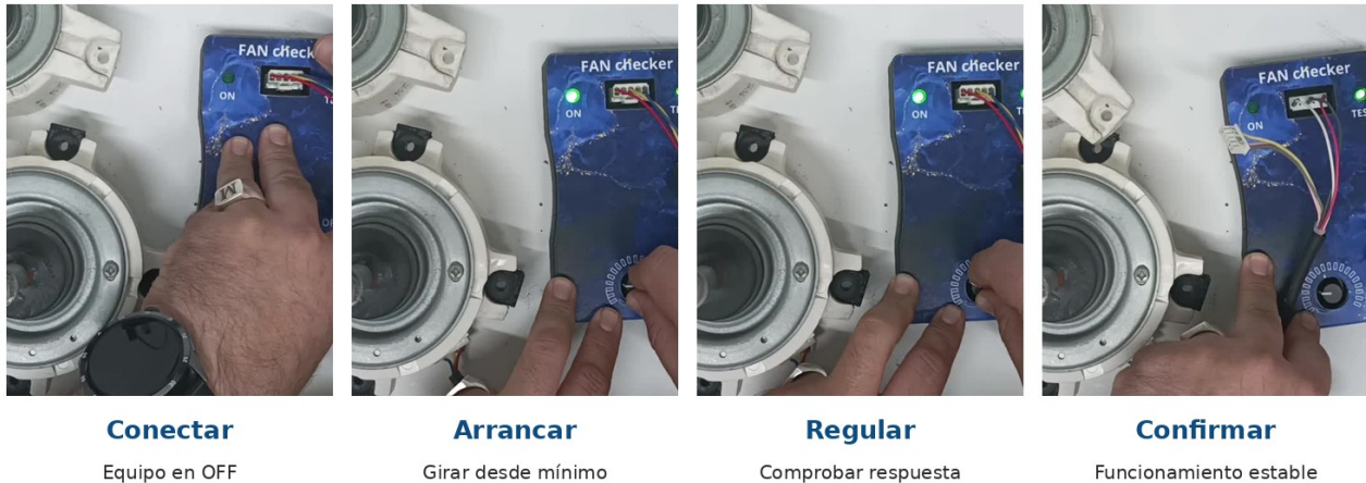
Figura 7. Secuencia recomendada de conexión, arranque, regulación y confirmación.
