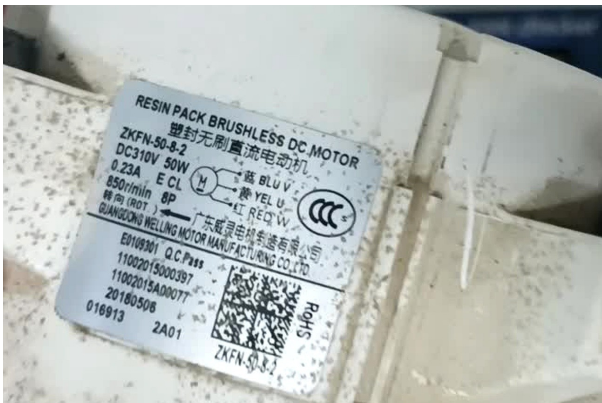
Figura 4. Placa de características del motor utilizado en la demostración.
