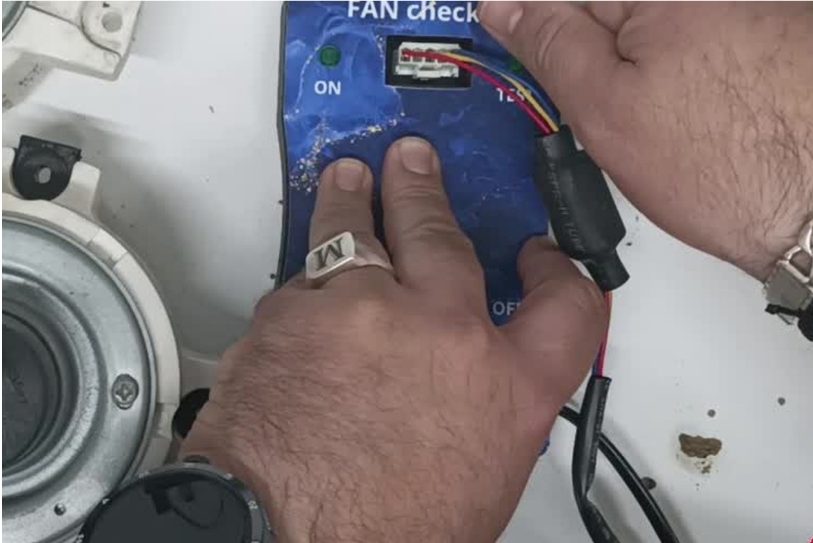
Figura 5. Conexión del motor al conector frontal mostrada en el vídeo.
