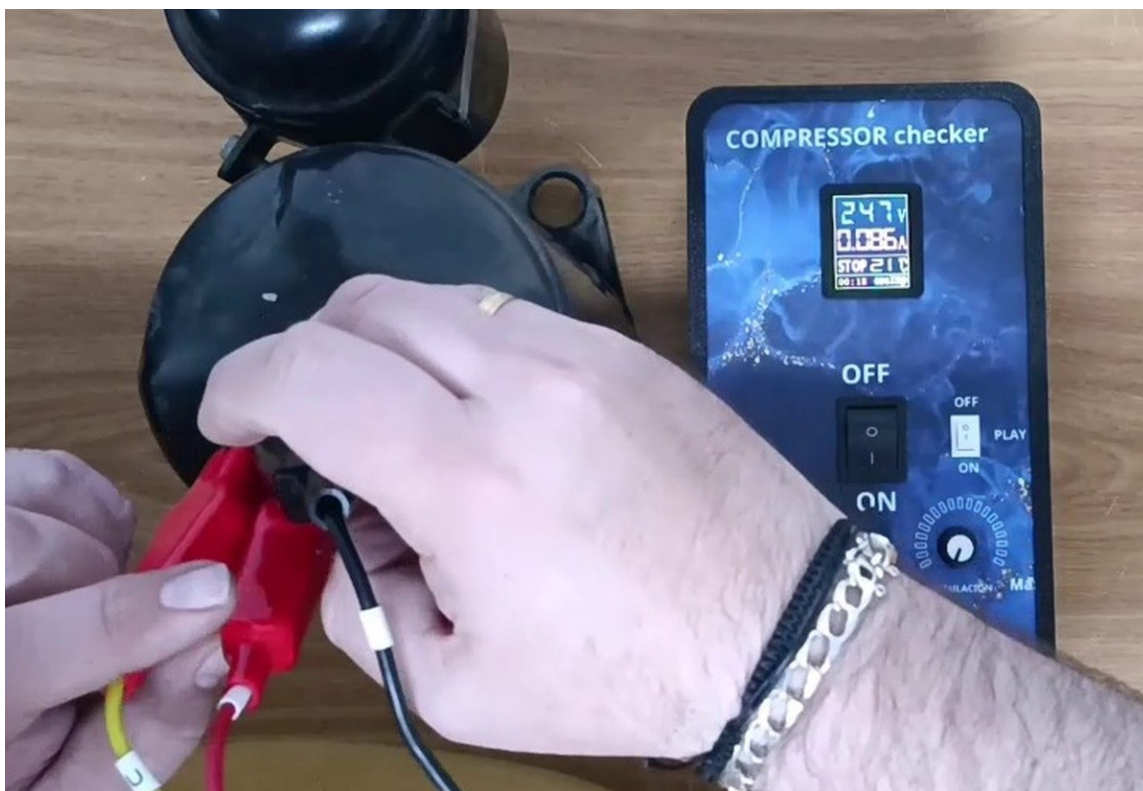
Figura 7. Conexión al bloque de terminales con el comprobador sin tensión.
