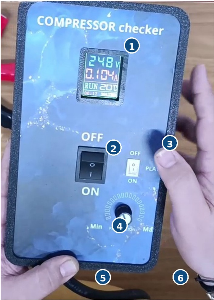
Figura 3. Controles, pantalla, alimentación de red y mazo trifásico U-V-W.
