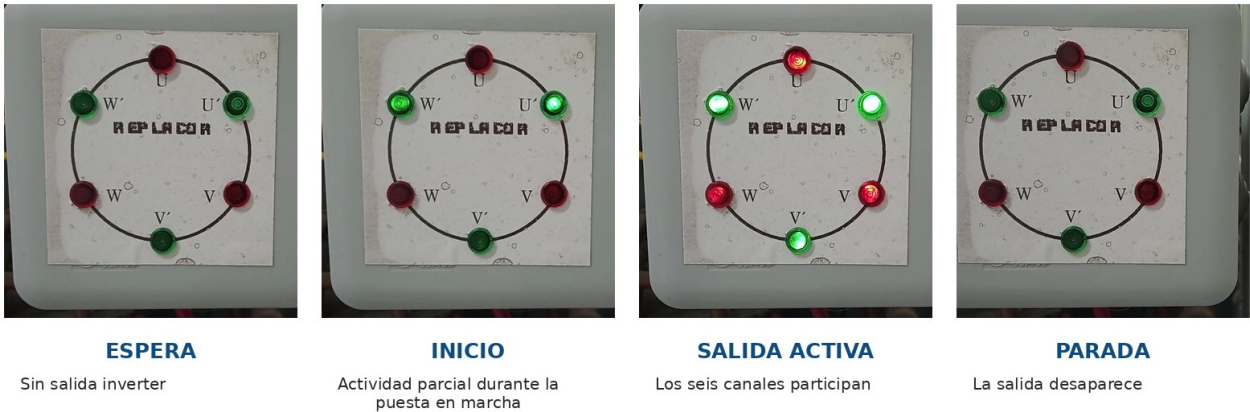
Figura 6. Espera, inicio, salida activa y parada.
