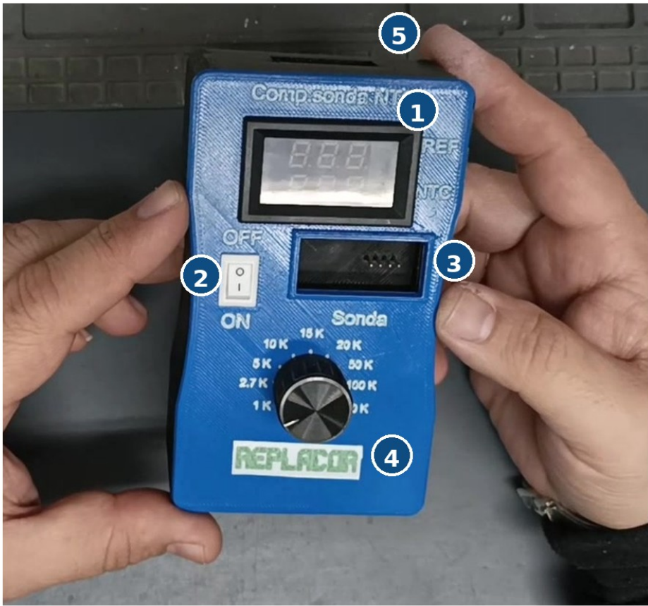
Figura 1. Identificación de los mandos y zonas principales del comprobador.
