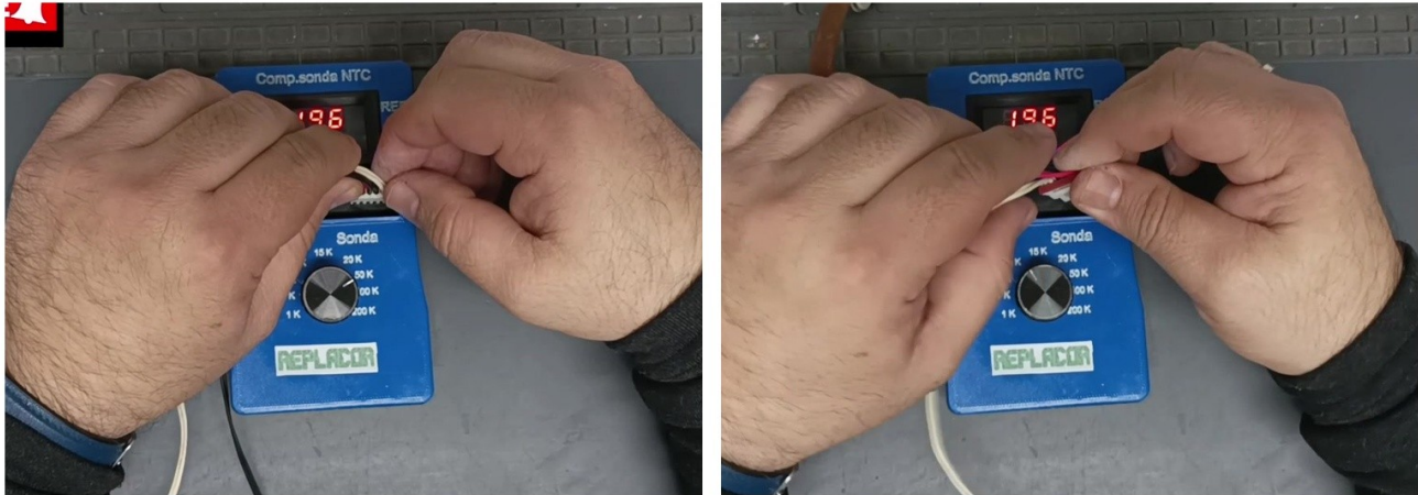
Figura 5. Ejemplos de conexión de pares pertenecientes a mazos con varios conductores.
