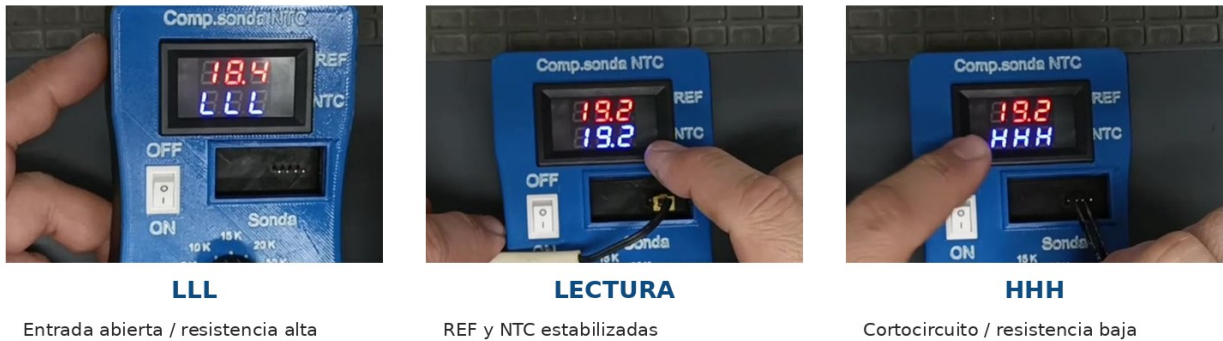
Figura 4. Estados principales observados en la pantalla del comprobador.
