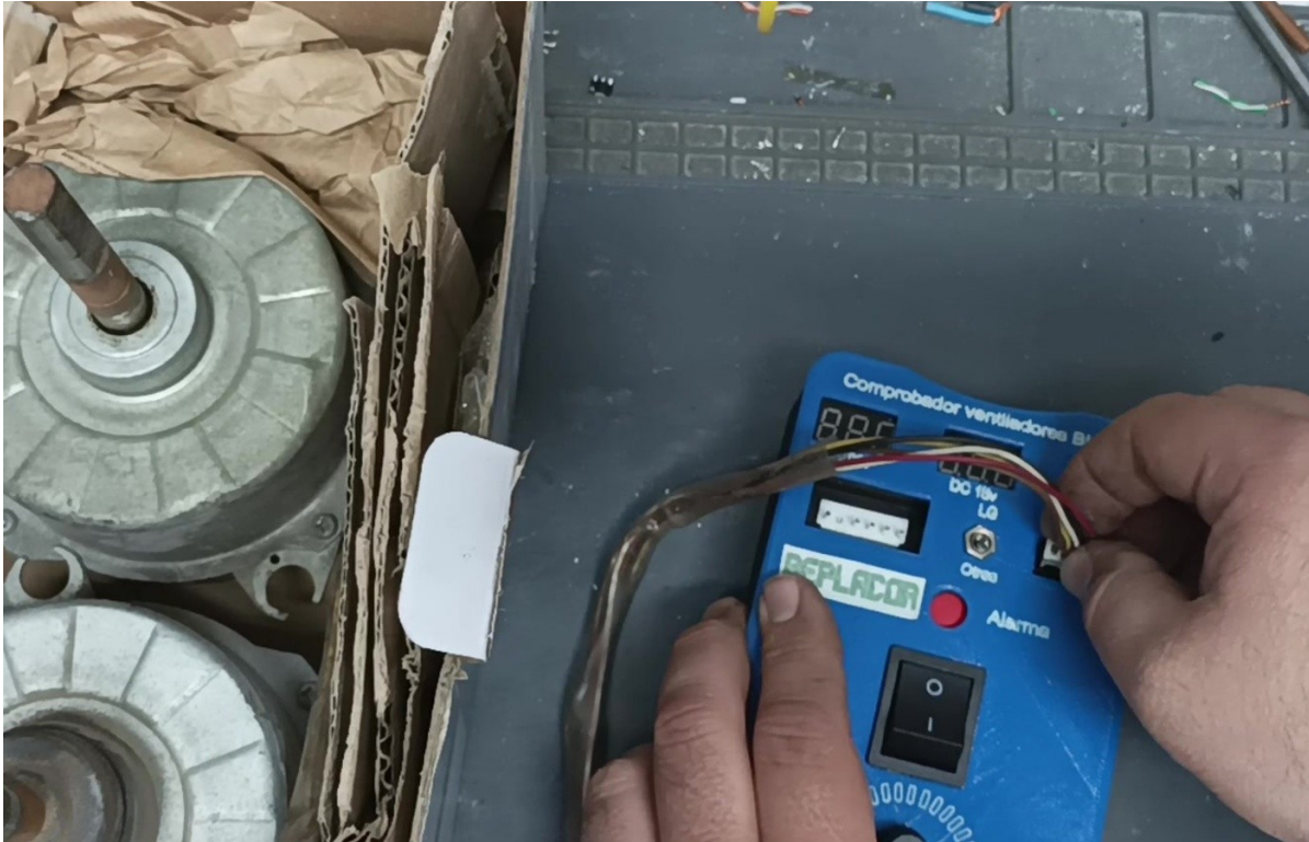
Figura 3. Toda conexión debe efectuarse con el interruptor en 0 y el regulador en MIN.
