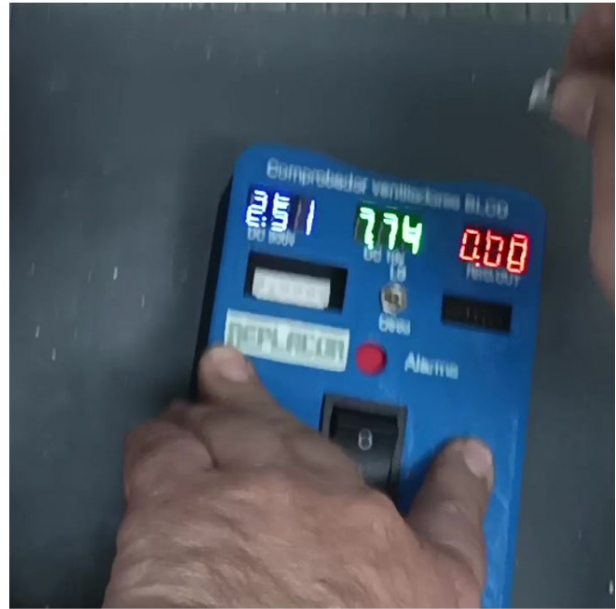
Figura 4. La regulación observada recorre aproximadamente desde 0,00 V hasta 7,00 V.
